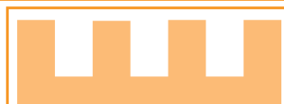
Llana con Diente Cuadrado de 1/4" x 3/8" x 1/4" (6 mm x 9.5 mm x 6 mm)
