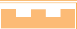
Llana con Diente Cuadrado de 1/4" x 1/4" x 1/8" (6 mm x 6 mm x 3 mm)
